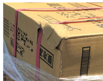
バンドの食い込みによる破損
