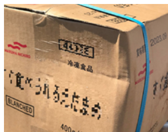
角の潰れによる破損
