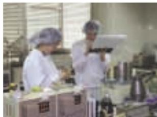
製品はサンプリングされ、官能検査、シール検査、細菌検査等が行われます。出荷製品のサンプルはロット毎に一定期間保管され、経時的分析も行います。
