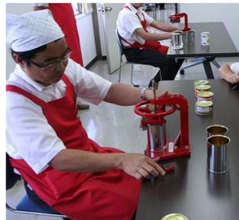
手動製缶機での巻き締め
